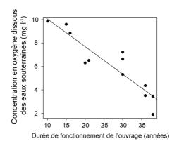
Figure 3 : Évolution des concentrations moyennes en oxygène dissous des eaux souterraines en fonction de la durée de fonctionnement de l'ouvrage.
