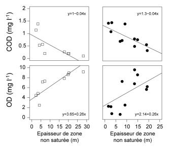
Figure 1 : Évolution des concentrations en Carbone Organique Dissous (COD) et en Oxygène Dissous (OD) dans les eaux souterraines en fonction de l'épaisseur de zone non saturée pour des sites de référence (colonne de gauche) et de recharge artificielle en eau pluviale (colonne de droite).
