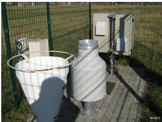
Figure 1 : Pluviographe à auget basculeur (premier plan) et à pesée (second plan)
