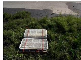
Figure 7. Piège à sédiment placé dans le compartiment décantation et prélèvements de sédiments frais lors de campagnes
