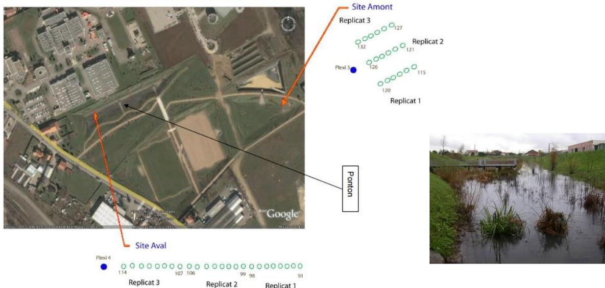
Figure 20 : Vue aérienne du bassin d'infiltration de Minerve (Saint-Priest) montrant la localisation et la disposition des différents piézomètres métalliques ainsi que ceux du ponton et plexiglass.
